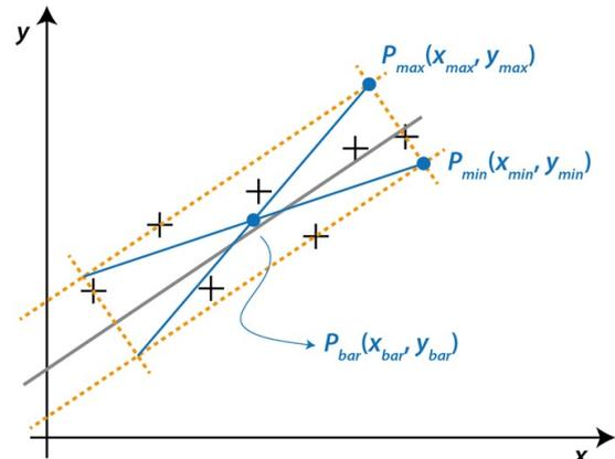
Determinar as inclinações máxima,  $B_{max} = \frac{y_{max} - y_{bar}}{x_{max} - x_{bar}}$ , e mínima,  $B_{min} = \frac{y_{min} - y_{bar}}{x_{min} - x_{bar}}$ ; calcular
